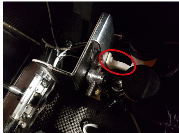
Abb. 4: Halterung für Zylinder beim Bremspedal
