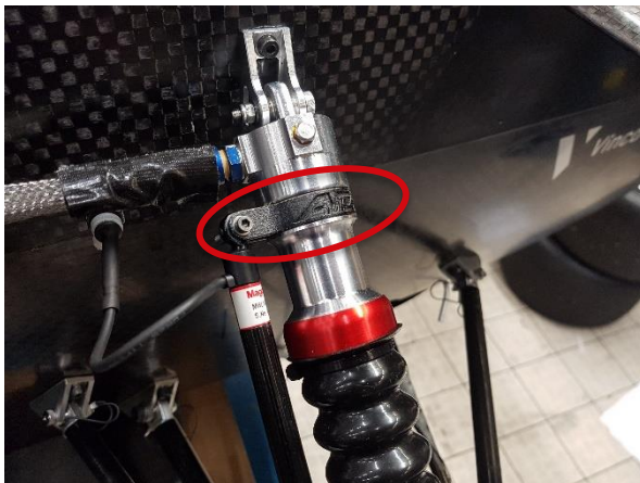
Abb. 3: Sensorhalterung am Pushrod der Radaufhängung
