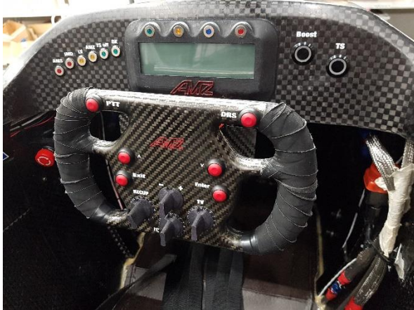
Abb. 1: Schalter am Lenkrad und Displayverschaltung
